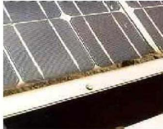
Modulschäden durch eindringendes Wasser und Mikroorganismen
