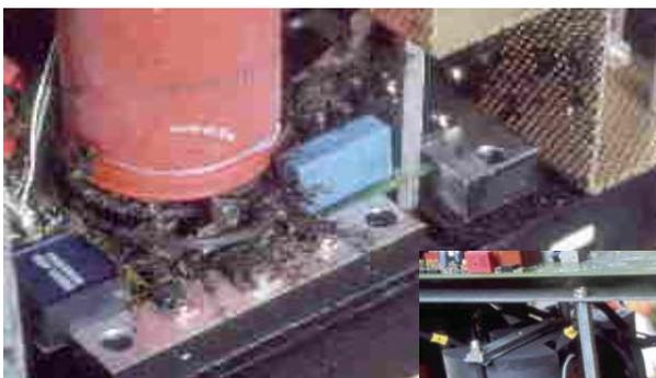
Durch hohe Spannungen kann es zur Zerstörung des Eingangskondensator im Wechselrichter kommen.
