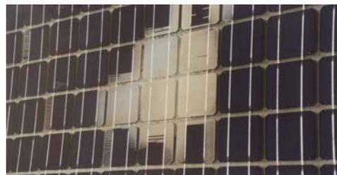
Delamination eines Moduls
